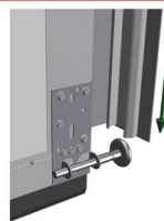
4e: Ta høyre veggskinne og tre ned over trinse på bunnbrakett, skru deretter veggskinne fast.
