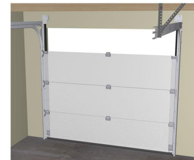
5d: Juster trinser så leddet blir stående i lodd
