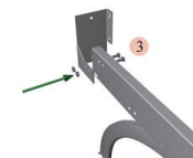
5a: Skru fast braketter for torsjonsfjærstang til takskinnene.
